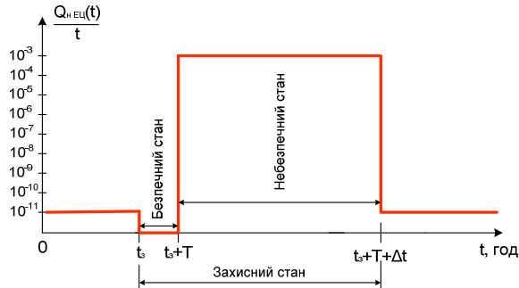
Рис. 5. Перехід системи ЕЦ в небезпечний стан після захисної відмови
