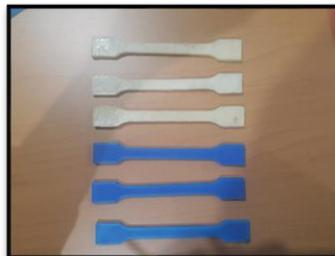
Figura 11. Probetas manufacturadas de color azul, por Impresión 3D y de color blanco, por moldeo de compresión.
