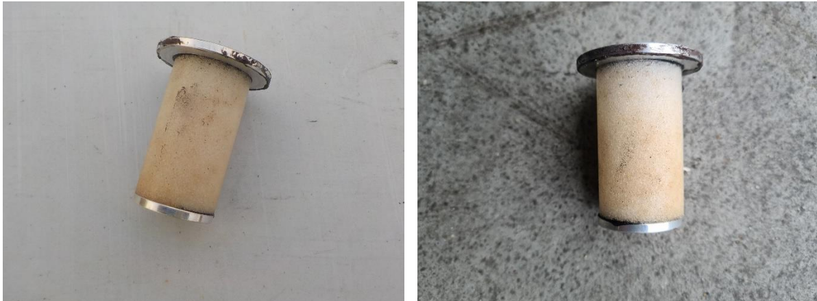
Figuur 13: Gasfilter voor aanvang van de testen met aardgas (links) en na afronding van de testen met waterstof (rechts)
