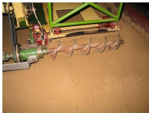
3-rasm. Vintli burg'uli kuchaytirgich bilan guruntni qazish jarayonining fotosuratlarini: a, b - chap tomonga o'rash (pichoq (otval)dan aylanish); v, g - pichoq (otval)ning old yuzasi va kuchaytirgichning spiral orasidagi bo'shliq.
