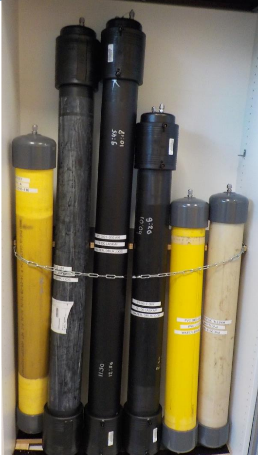
Figuur 5. Een deel van de PVC- en PE-buizen waarin water is aangebracht.
