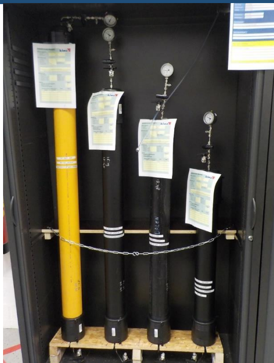
Figuur 4. Vier PE-buizen waarin 500 mbar(o) waterstofgas is aangebracht.
