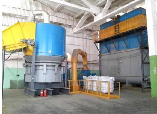
Рис. 16. Приёмный бункер исходного сырья и промежуточный накопитель. Источник: фото авторов.
