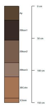
$\mbox{\bf Ap} \quad 0\mbox{-}22~\mbox{cm};$  grisáceo muy oscuro (10YR 3/2) en húmedo; gris (10YR 5/1) en seco; franco arcillo limoso; bloques subangulares medios que rompe a granular; friable; no plástico, no adhesivo; raíces abundantes; límite inferior abrupto, suave.
