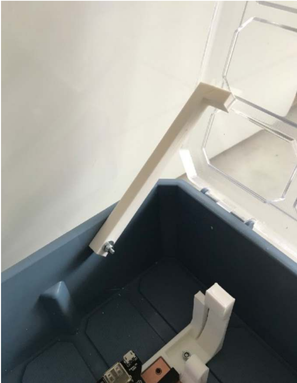
Abb. 10: Kofferbau, Schritt 4: Haltestab anschrauben
