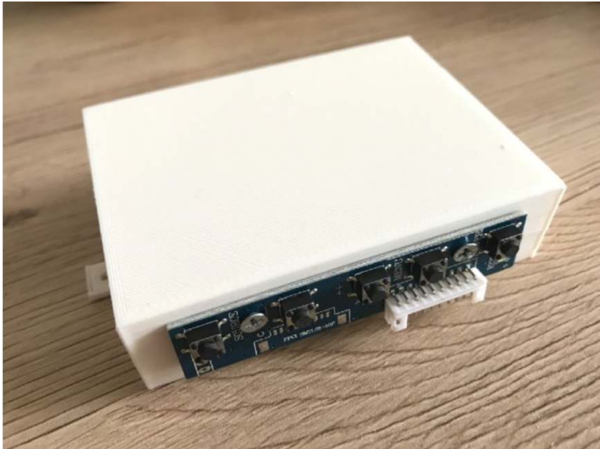
Abb. 14: Kofferbau, Schritt 8: Display Controller anschrauben
