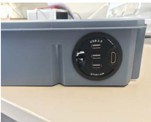
Abbildung D.7.: Herausgeführte USB-Anschlüsse und HDMI-Ausgang
