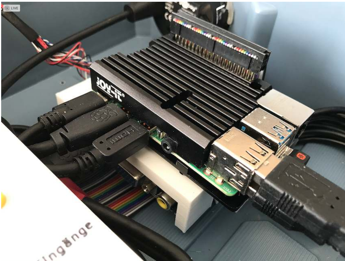
Abb. 18: Kofferbau, Schritt 10: Display-Controller Gehäuse am Koffer befestigen
