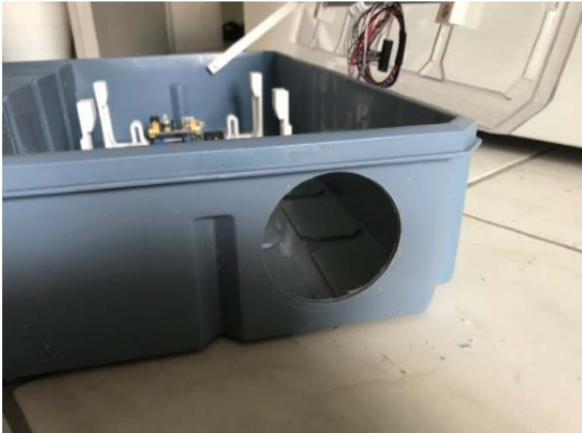
Abb. 12: Kofferbau, Schritt 6: Loch für USB-Hub bohren
