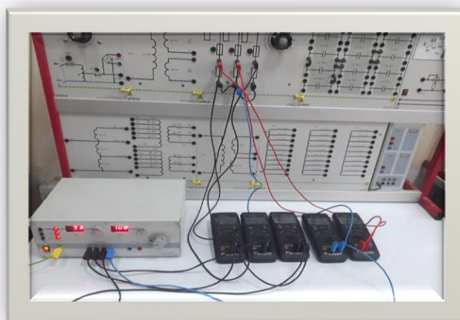
3- sxema. Uch fazali elektr zanjirlarni oddiy qarshiliklar orqali yulduz ulash sxemasi.
