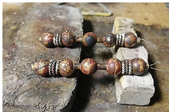
Рис. 11. Изготовление полусфер из листового металла и колечек из скани. Нанизывание деталей на основу и пайка
