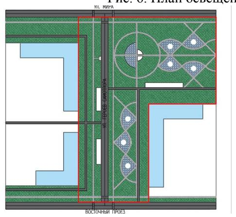
Рис. 8. Схема покрытий на участке
