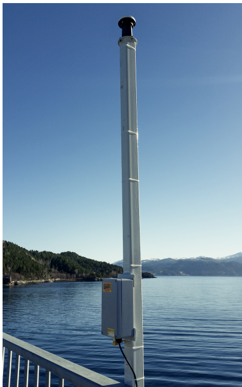
(d) Trimble RTK GNSS, displacement sensor.
