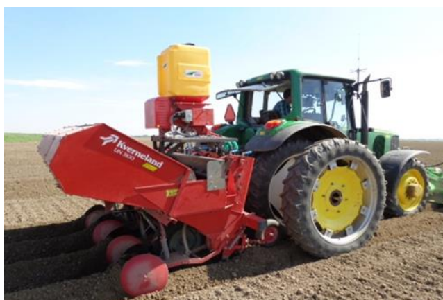
Figure 2. Exemple de l'application de granulés Minigran® à l'aide d'un microgranulateur lors du semis. (Photo: DCM)
