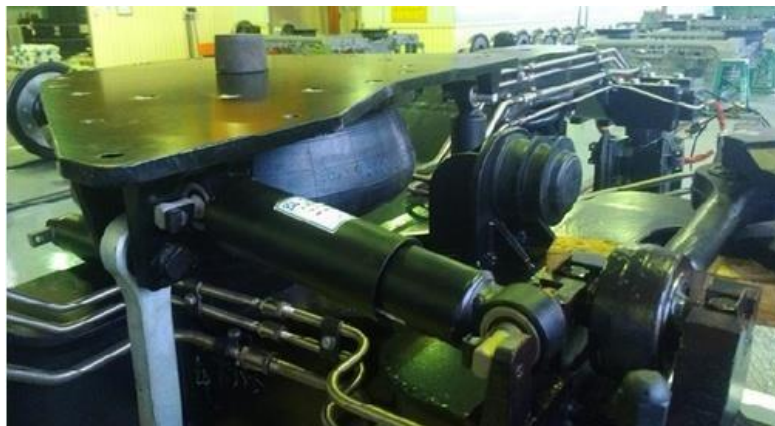
Рисунок 7.51 – Центральна ступінь ресорного підвішування
