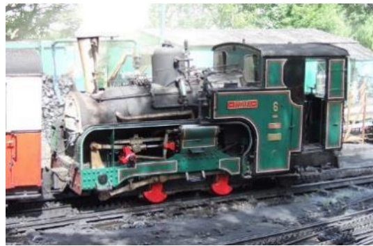
Рисунок 7.15 – Паровоз «Padarn» (SLM 0-4-2T 2838) – найвідоміший у світі локомотив для гірських залізниць з зубчато-рейковим приводом (1922р.) [157]
