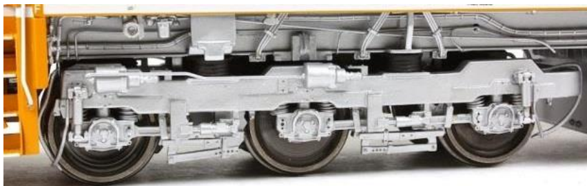
Рисунок 7.17 – Тривісний локомотивний візок HTCR-II Trucks з радіальною установкою колісних пар
