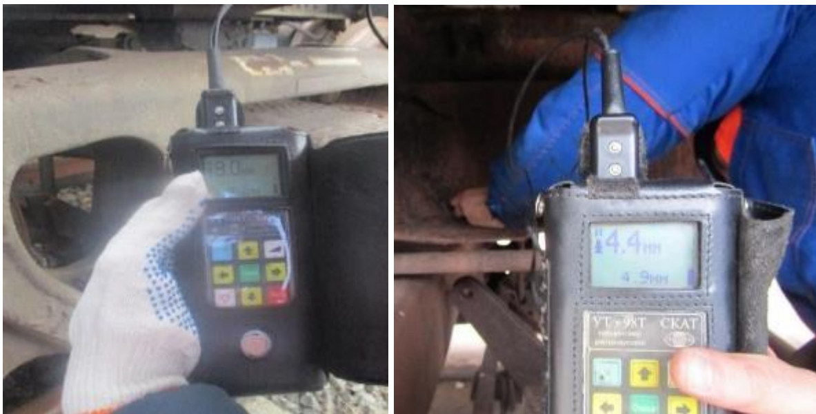
Рисунок 7.10 – Приклад вимірювання товщини УТ методом металевих конструкцій вантажних вагонів
