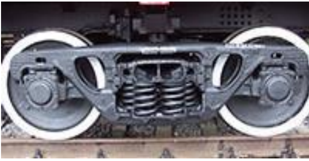
Рисунок 5.7 – Візок моделі 18-9771 виробництва ООО «КВЗ» (Росія) [99]
