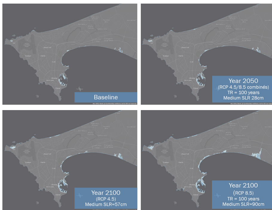
Figure 8. Inondations côtières(en bleu)en 2050 et 2100 selon différents scénarios de changement climatique et par rapport au scénario de référence (risque d'inondation actuel).
