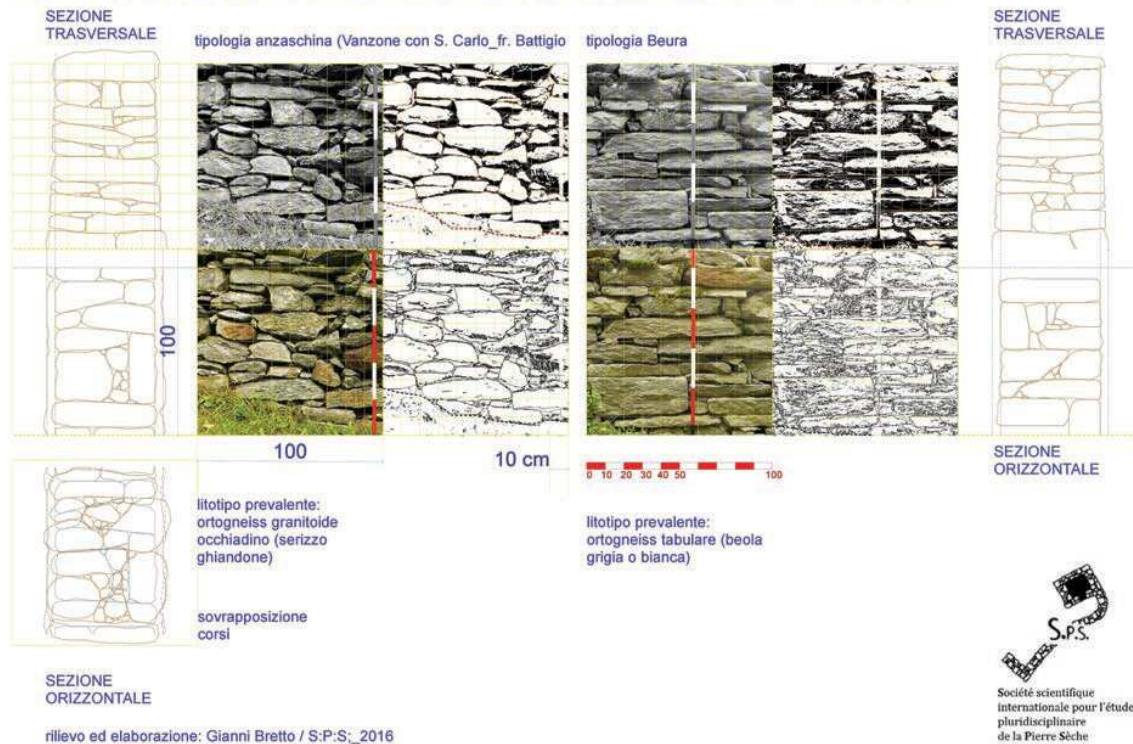
Fig.2 Muro parcellare in pietra a secco, tipologie di apparecchiatura muraria al variare dei litotipi. (Valle Anzasca e Beura Cardezza). (Disegno: Gianni Bretto/SPS)
