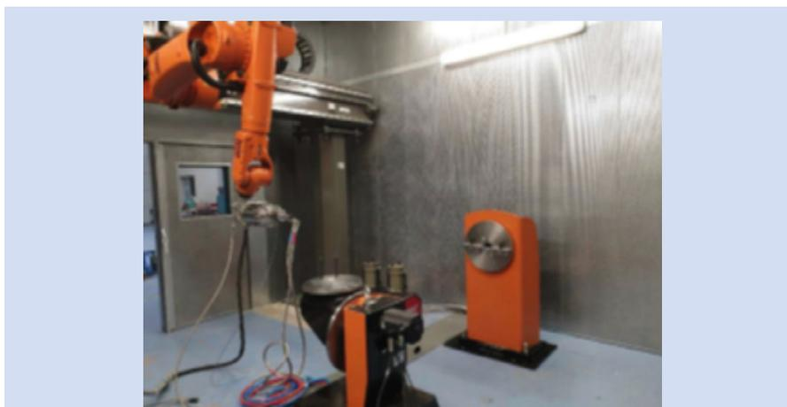
FIGURE 2 : Robot Kuka avec pistolet de projection Impact Innovation 5/11 et les vireurs et positionneurs dans la cabine de projection.
