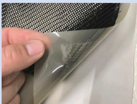
FIGURE 6 : Intégration du film thermoplastique pendant le processus LRI.
