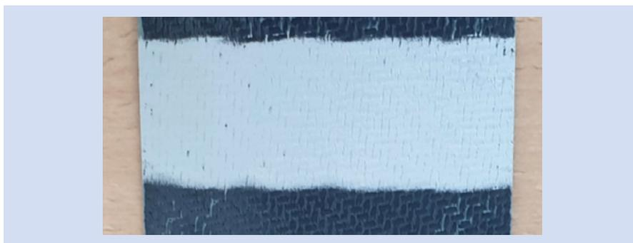
FIGURE 11 : Plaque de composite (100 \* 40 mm) revêtue par la poudre d'aluminium -50 + 20 µm.
