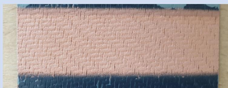
FIGURE 8 : Plaque de composite (100 x 40 mm) revêtue par la poudre cuivre-38 +15 µm.
