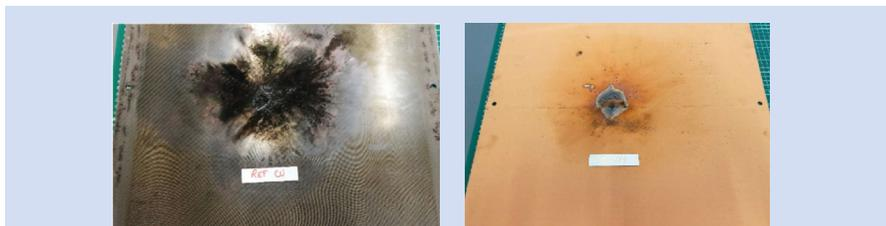
FIGURE 14 : Test foudre sur une référence (gauche) et la plaque revêtue de cuivre par cold spray (droite).
