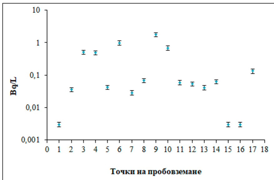
Фиг. 4. Обща алфа-активност в изследваните минерални води
