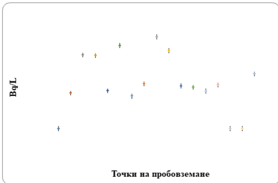
Фиг. 4. Обща алфа-активност в изследваните минерални води
