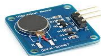
Fig. 5. Vibration motor module
