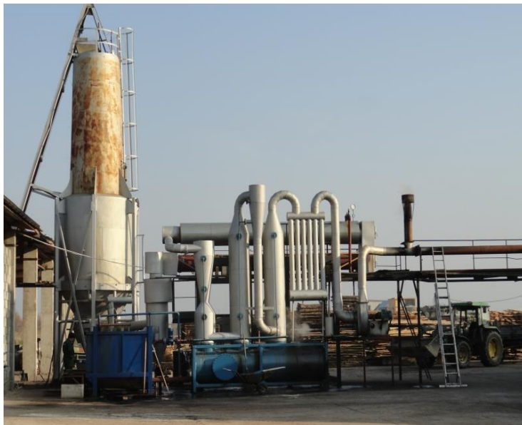
Рис. 3. Рис.9. Газогенератор «Экотехнопром – 1000 кВт» Республика Татарстан, Казань. Источник: yandex.ru/images.
