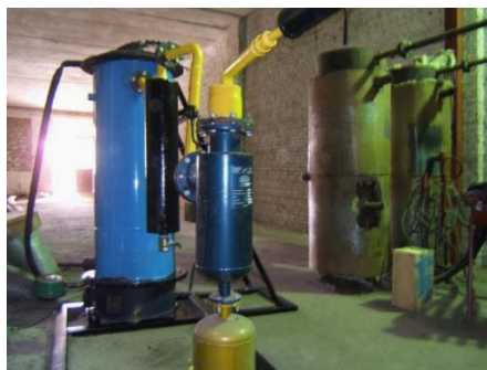
Рис. 7. Газогенератор ГТ-1-500, (500 кВт), Ростов-на-Дону. Источник: yandex.ru/images .
