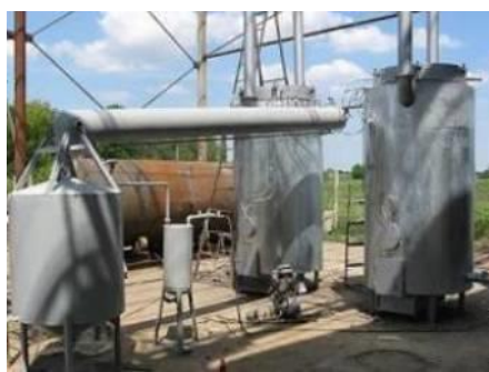
Рис. 8. Газогенератор 200 кВт, «Металлоконструкция», Тюмень. Источник: yandex.ru/images .
