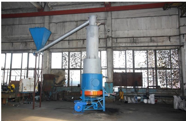
Рис. 6. Газогенератор УГЛАС-800 (800 кВт), Ростов-на-Дону. Источник: yandex.ru/images .
