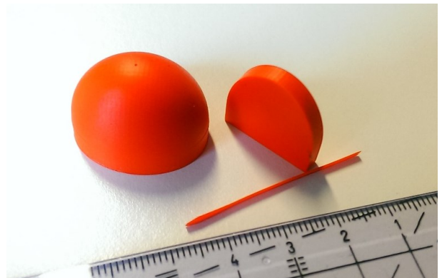
Fig. 9. Prototyped plastic antennas.
