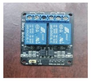
Fig. 5. Relay module
