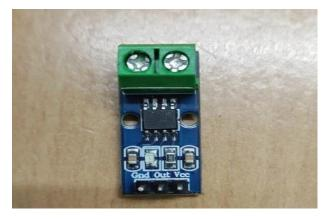
Fig. 7.ACS712 Sensor module
