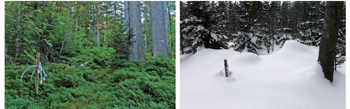
Abb. 115: Eine der rund 752 Lysimeter Installationen verteilt auf 47 Standorten der Interkantonalen Walddauerbeobachtung. Versuchsfläche Scheidwald (BE) im Sommer (links) und Winter (rechts). Die Lysimeter haben durch die isolierende Boden- oder Schneeschicht meistens auch im Winter Wasser.
