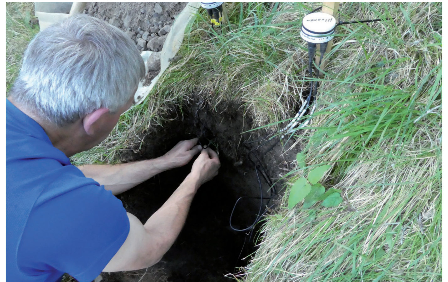
Setzen von Bodenwassersonden.
