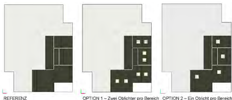
Abbildung 63: Parametervariationen für die Neigung des Fensters: Oblichter (Draufsicht Gebäude).
