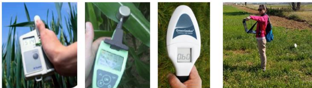
Figura 1: Varios sensores ópticos manuales para medir el estado nutricional del cultivo. La imagen de la derecha muestra un espectrorradiómetro de campo más sofisticado que se utiliza para comparar la medición de los equipos comerciales.
