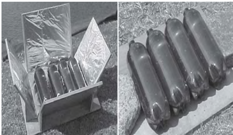
Figura 11 – SODIS com e sem a utilização do concentrador solar Fonte: Paterniani e Silva (2005).
