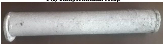
Fig. 2. Semisolid cast A319 alloy billet
