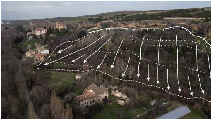
Figura 43. Vista aérea lateral del deslizamiento de la Huerta Grande. Foto: Rodrigo Verdugo Vicente.
