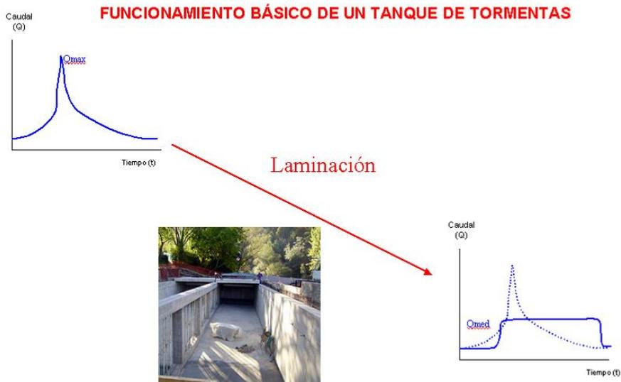
Figura 84. Funcionamiento de un tanque de tormentas, laminando el caudal punta del hidrograma de avenida súbita y transformando el pico en una meseta de caudal que se prolonga en el tiempo. Vista del interior del tanque de tormentas bajo la pradera de San Marcos.
