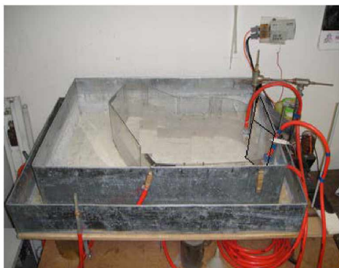
Рис. 2. Лабораторная модель бассейна-охладителя с орографической вкладкой и сифоном с щелевым затвором (слева); контур границ натурального водохранилища (справа).
