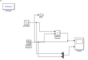
Fig. 5. Sinusoidal PWM Technique
