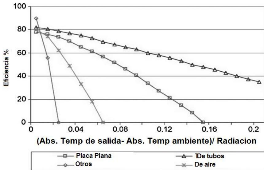
Figura 6. Eficiencia según el tipo de colector. Fuente Saidur (2011)
