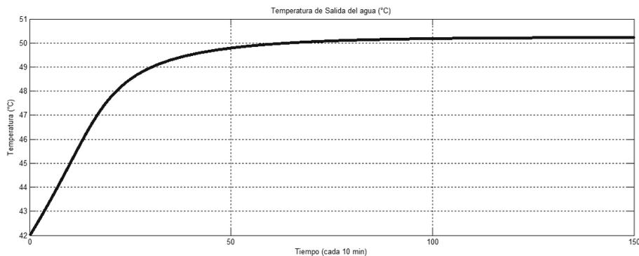
Figura 11. Respuesta del Sistema con Control PI óptimo. Fuente propia.
