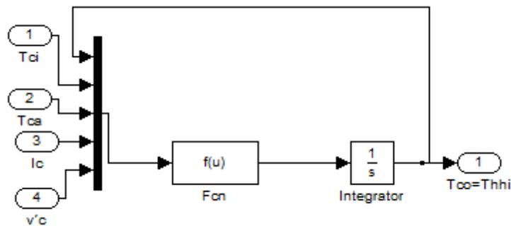
Figura 7. Esquema simulado del colector. Fuente propia.
