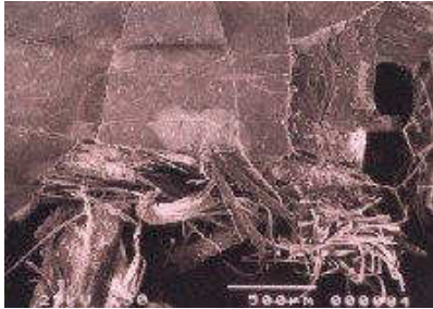
صورة (6) باستخدام جهاز (SEM) توضح ضعف الحامل الكتاني.
