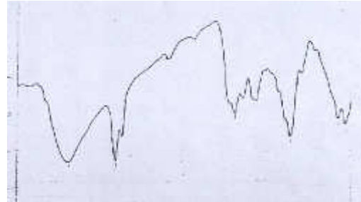
شكل(1) تحليل طيف الاشعة تحت الحمراء لطبقة الورنيش.
