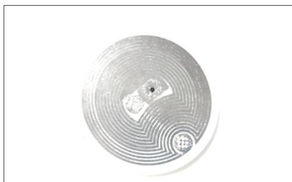
Figura 6. Tags Etiqueta RFID de 13,56 Mhz ISO14443A
