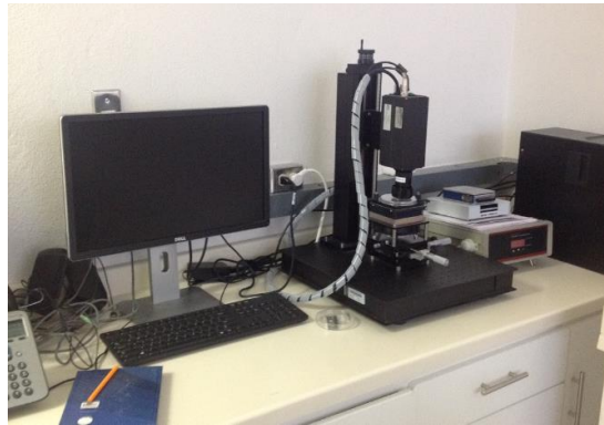
Figura 14. Cámara infrarroja, (Optotherm EL InfraSight 320) con una resolución espacial de 5 \mu\text{m}/\text{pixel} .
