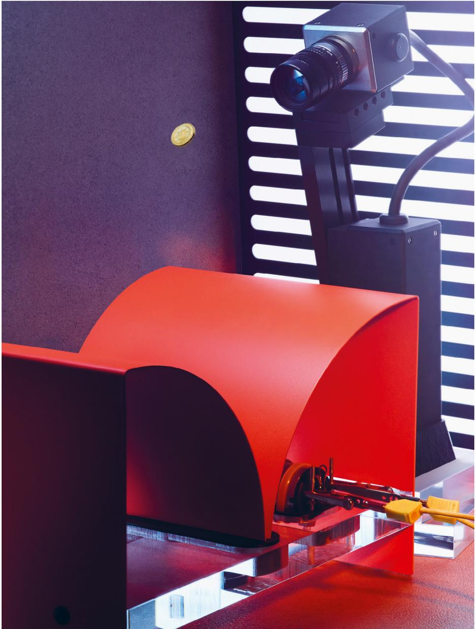
**La règle empirique** : Exemplaire original datant de 2039. Une machine d'apparence futuriste qui projette en l'air une pièce de monnaie grâce à un mécanisme rotatif à répétition. Une caméra ultra-rapide mesure les résultats – pile ou face – et les traduit en une chaîne de zéros et de uns (photographie : Tobias Siebrecht).
