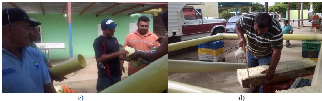
Figura 1. Construcción balsa artesanal: a. pegado de las uniones, b. armazón, c. pegado de la fibra de vidrio d. cortado de los bloques de poliuretano
