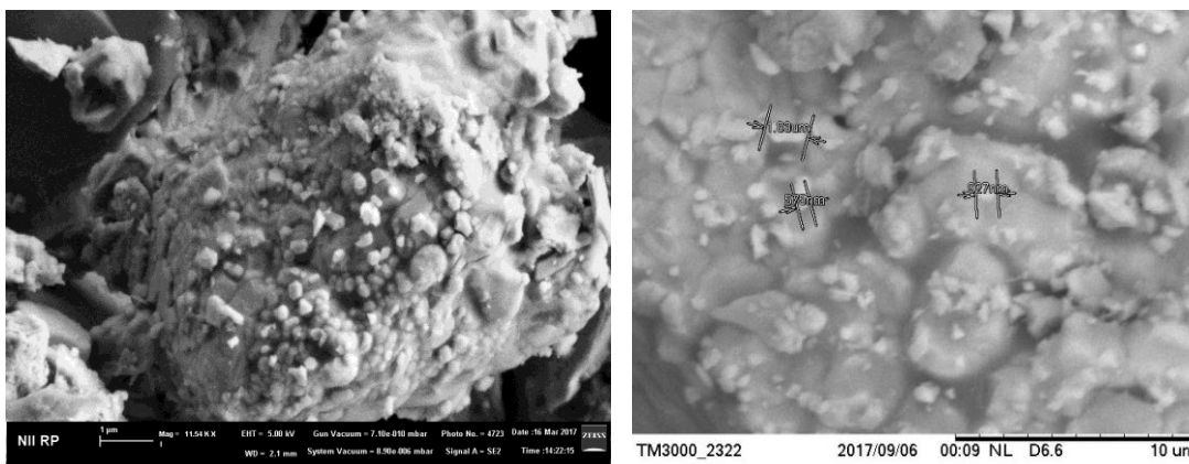
Рис. 4. Микрофотографии образцов феррита меди, полученных микроволновым синтезом из оксидов (а) и золь-гель методом с горением и дожигом в поле СВЧ (б).
