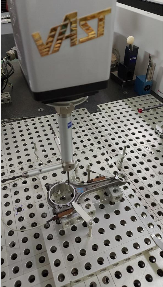
Biyel Kolu (Connecting Rod) Ölçüm Pozisyonları
