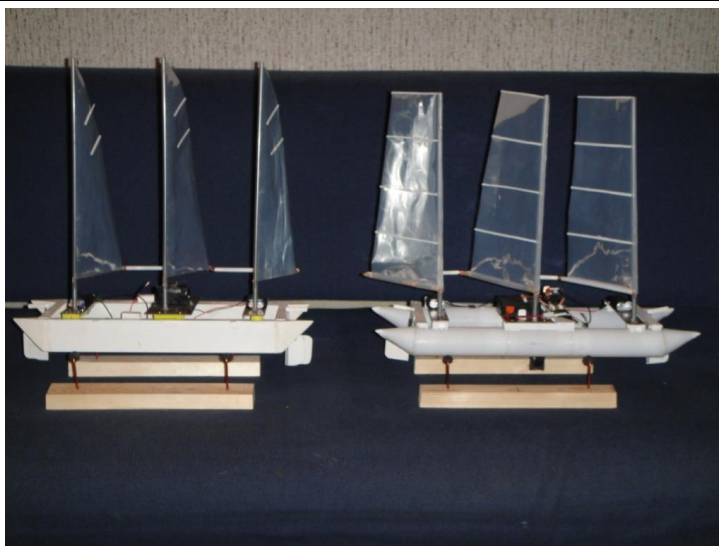
Рис. 11. Изображения второго (слева) и третьего (справа) вариантов макета парусной энергетической установки
