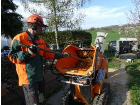
Abbildung 3: Zerkleinerung der Hackschnitzel mit einem Gartenhäcksler.
