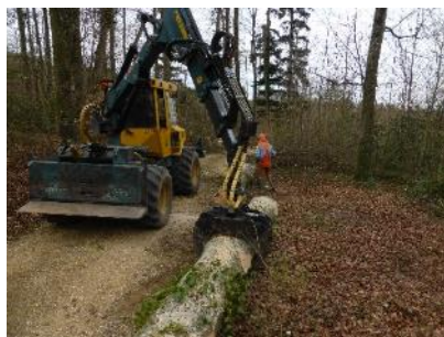
Aufarbeitung und Sortimentseinteilung mit einem Harvester und motormanuell mit Hilfe eines Zangenschleppers
