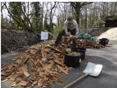
Entnahme der Mischproben aus den Hackholzhaufen
