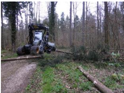
Aufarbeitung und Sortimentseinteilung mit einem Harvester und motormanuell mit Hilfe eines Zangenschleppers
