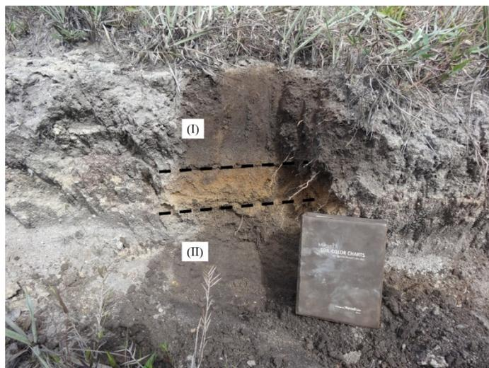
Figura 7. Parte superior do Cambissolo do topo 1. I: Horizonte A1; II: horizonte 2A
