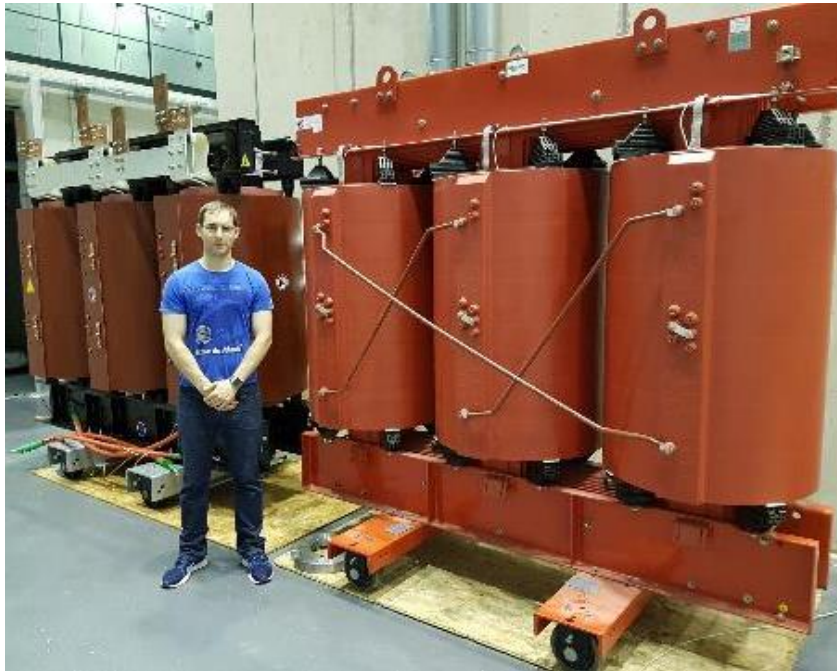
4,5 MVA, 50 Hz Transformator 11.500 kg (2,5 kg/kVA)
