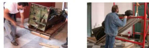
Εικόνα: Μεταφορά σε κυλιόμενο φορείο με κατρακίλια
