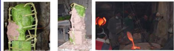
Εικόνες: Κατασκευή δευτερογενούς εκμαγείου, χύτευση χαλκού στο δευτερογενές εκμαγείο (φάσεις 4, 5, 7)
