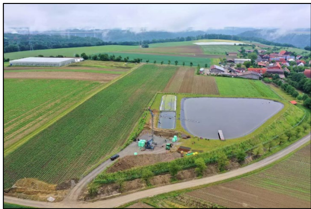
Abbildung 6: links: Stahlsilo bei einem Beerenproduzenten in Aesch LU mit 805 \text{ m}^3 Speicherkapazität (Eppenberger 2020); rechts: zwei kleinere Teiche klären das Wasser, bevor es in den grossen Bewässerungsspeicher ( 20.000 \text{ m}^3 ) fliesst, Gemüseproduzent in Deutschland (Foto: (Deter and Eghbal 2020) bioland-Fachmagazin).
