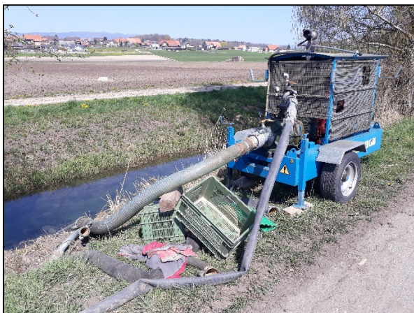
Abbildung 16: Mit Dieselmotoren betriebene Pumpen fördern Bewässerungswasser auf die Felder im Seeland (Fotos: Elke Kellner).
