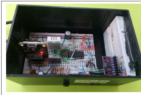
Figure 3 : Le modèle du système APOMOS pour mesurer les concentrations du NO 2
