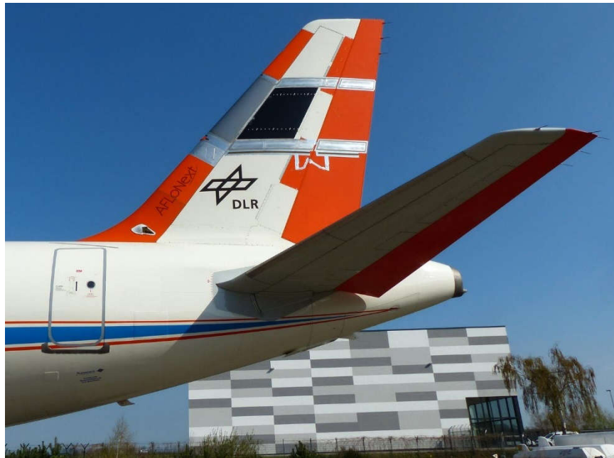
Flight testing of HLFC, Source: F. Dambowsky, G. v. Schweppenburg, G. Ernst. Treibstoffverbrauch durch Absaugung senken: DLR-Forschungsflüge mit revolutionärem Seitenleitwerk . 24.04.2018
