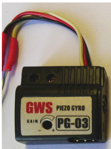
Slika 3: Fotografija GWS PG-03 Žiroskopa u laboratoriji 69 na Elektrotehničkom fakultetu u Beogradu.
