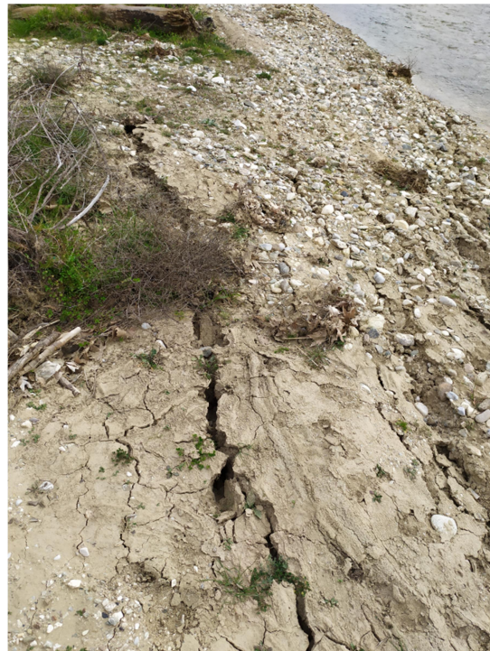
Εικόνα ΓΕΩ11. Χαρακτηριστικές αποτυπώσεις φαινομένου ρευστοποίησης και επαγόμενης πλευρικής εξάπλωσης στην ευρεία κούη του Τηταρήσιου ποταμού (Θέση L2) (Συν/νες θέσης φωτογραφίας: N39°43'31.74"; E22°8'20.28" (αριστερά πάνω), N39°43'31.43"; E22°8'19.16" (αριστερά κάτω) N39°43'32.83"; E22°8'16.60" (δεξιά))
