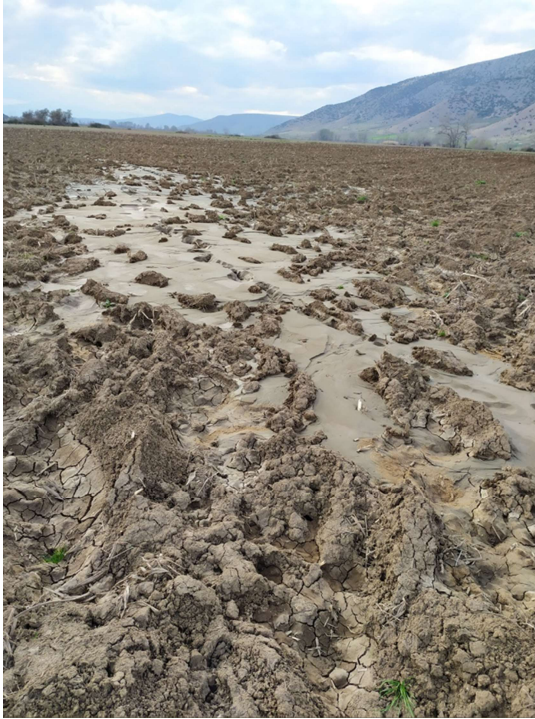
Εικόνα ΓΕΩ14. Αποτύπωση εκτεταμένης ρευστοποίησης σε θέσεις νοτίως της Πηνειάδας πλησίον του ποταμού Πηνειού (Θέση L3) (Συν/νες θέσης φωτογραφίας: N39°34'53.21"; E22°10'39.77" (αριστερά), N39°34'54.57"; E22°10'41.94" (δεξιά))
