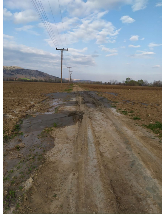
Εικόνα ΓΕΩ14. Αποτύπωση εκτεταμένης ρευστοποίησης σε θέσεις νοτίως της Πηνειάδας πλησίον του ποταμού Πηνειού (Θέση L3) (Συν/νες θέσης φωτογραφίας: N39°34'53.21"; E22°10'39.77" (αριστερά), N39°34'54.57"; E22°10'41.94" (δεξιά))
