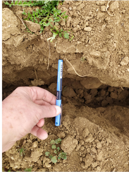
Εικόνα ΓΕΩ13. Φωτογραφίες αποτύπωσης της εδαφικής ρωγμής πεταλοειδούς σχήματος με ένδειξη της διάστασής της ως προς τη σχετική οριζόντια και την κατακόρυφη μετακίνηση των δύο μερών. (Συν/νες θέσης φωτογραφίας: N39°44'10.01"; E22°6'56.87" (αριστερά πάνω), N39°44'9.87"; E22°6'56.96" (δεξιά πάνω), N39°44'10.39"; E22°6'55.99" (αριστερά κάτω) N39°44'11.31"; E22°6'54.15" (δεξιά κάτω))
