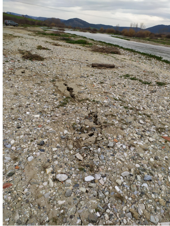
Εικόνα ΓΕΩ10. Χαρακτηριστικές αποτυπώσεις φαινομένου ρευστοποίησης και επαγόμενης πλευρικής εξάπλωσης στην ευρεία κούη του Τηταρήσιου ποταμού (Θέση L1) (Συν/νες θέσης φωτογραφίας: N39°44'5.50"; E22°6'52.89" (αριστερά πάνω), N39°44'4.88"; E22°6'53.81" (αριστερά κάτω) N39°44'5.45"; E22°6'51.51" (δεξιά))
