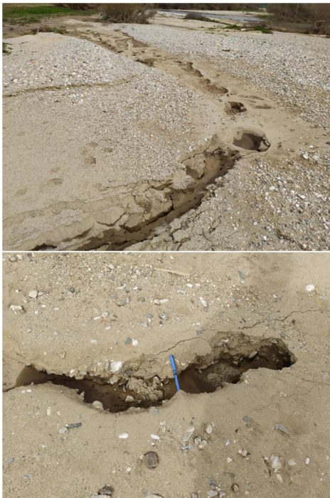
Εικόνα ΓΕΩ11. Χαρακτηριστικές αποτυπώσεις φαινομένου ρευστοποίησης και επαγόμενης πλευρικής εξάπλωσης στην ευρεία κούη του Τηταρήσιου ποταμού (Θέση L2) (Συν/νες θέσης φωτογραφίας: N39°43'31.74"; E22°8'20.28" (αριστερά πάνω), N39°43'31.43"; E22°8'19.16" (αριστερά κάτω) N39°43'32.83"; E22°8'16.60" (δεξιά))
