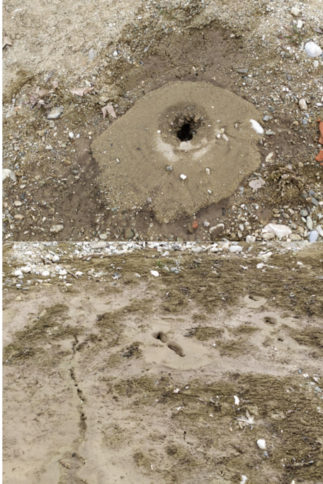
Εικόνα ΓΕΩ10. Χαρακτηριστικές αποτυπώσεις φαινομένου ρευστοποίησης και επαγόμενης πλευρικής εξάπλωσης στην ευρεία κούη του Τηταρήσιου ποταμού (Θέση L1) (Συν/νες θέσης φωτογραφίας: N39°44'5.50"; E22°6'52.89" (αριστερά πάνω), N39°44'4.88"; E22°6'53.81" (αριστερά κάτω) N39°44'5.45"; E22°6'51.51" (δεξιά))
