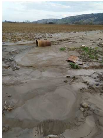
Εικόνα ΓΕΩ15. Αποτύπωση εκτεταμένης ρευστοποίησης σε θέσεις νοτίως της Πηνειάδας πλησίον του ποταμού Πηνειού (Θέση L4) (Συν/νες θέσης φωτογραφίας: N39°34'56.05"; E22°10'8.24" (αριστερά), N39°34'56.18"; E22°10'8.16" (μέση), N39°34'56.04"; E22°10'8.25" (δεξιά))
