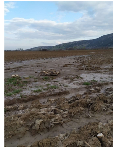
Εικόνα ΓΕΩ15. Αποτύπωση εκτεταμένης ρευστοποίησης σε θέσεις νοτίως της Πηνειάδας πλησίον του ποταμού Πηνειού (Θέση L4) (Συν/νες θέσης φωτογραφίας: N39°34'56.05"; E22°10'8.24" (αριστερά), N39°34'56.18"; E22°10'8.16" (μέση), N39°34'56.04"; E22°10'8.25" (δεξιά))
