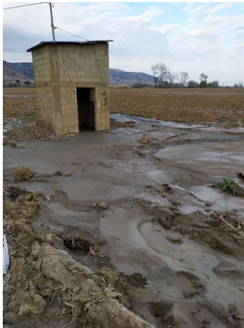
Εικόνα ΓΕΩ15. Αποτύπωση εκτεταμένης ρευστοποίησης σε θέσεις νοτίως της Πηνειάδας πλησίον του ποταμού Πηνειού (Θέση L4) (Συν/νες θέσης φωτογραφίας: N39°34'56.05"; E22°10'8.24" (αριστερά), N39°34'56.18"; E22°10'8.16" (μέση), N39°34'56.04"; E22°10'8.25" (δεξιά))
