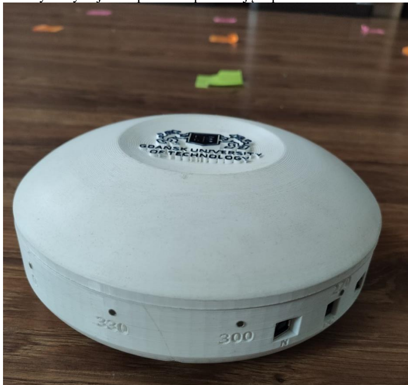
Rysunek 2. Antena ESPAR w obudowie, zapewniona przez KIMiA.
