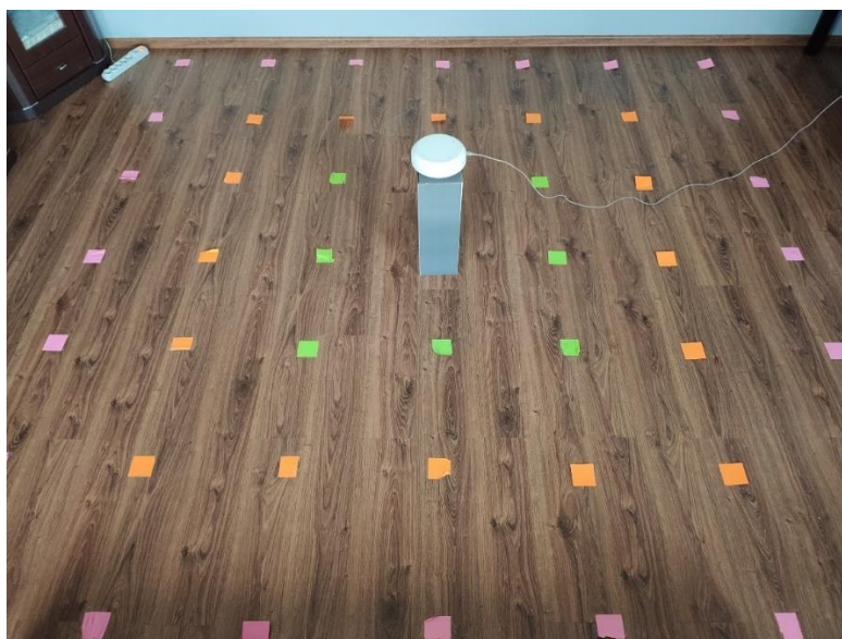
Rysunek 12. Ustawienie układu pomiarowego w pomieszczeniu wraz z anteną znajdującą się w samym środku siatki pomiarowej, 50 cm nad nią.
