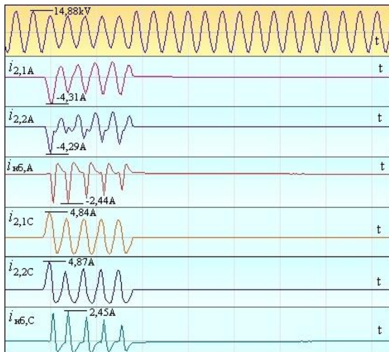
Рисунок 3 Осциллограмма второго ложного срабатывания ДЗ
